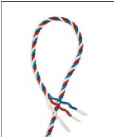
1. Die drei Litzen des Seils mindestens drei Umdrehungen aufdrehen.
