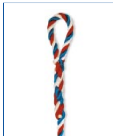
5. Die übrigbleibenden Tau-Enden werden am Spleißende getakelt.
